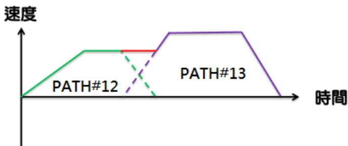
**插斷命令：**任何一種控制類型皆可設定插斷與否，且插斷是在下一段程序做設定。SDE PR 模式中有分成內部插斷和外部插斷。
