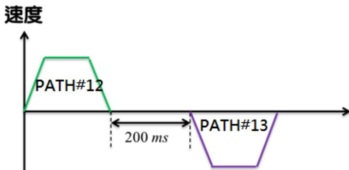
**PATH#12**(AUTO 定速控制、目標速度:2000 rpm、延遲時間: 200 ms) → **PATH#13**(定位控制、絕對定位:0 pulse)
