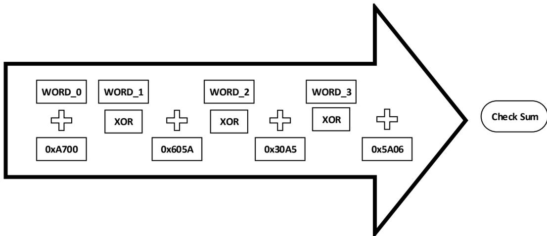
$$\text{Check Sum} = ((((((\text{WORD}_0 + 0xA700) \text{ xor } \text{WORD}_1) + 0x605A) \text{ xor } \text{WORD}_2) + 0x30A5) \text{ xor } \text{WORD}_3) + 0x5A06$$
