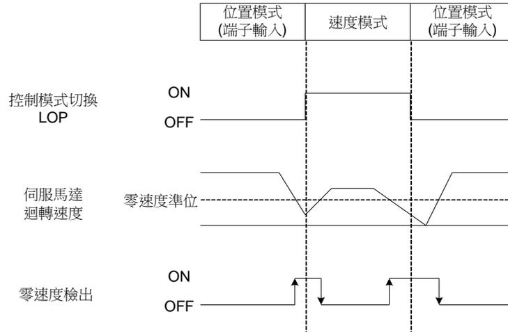
若馬達處於高速運轉時，無法進行模式切換。數位輸出(DO)零速度輸出端子(ZSP ON)時，即可進行控制模式切換，但還是建議使用者等待馬達完全停止後再進行模式切換。
