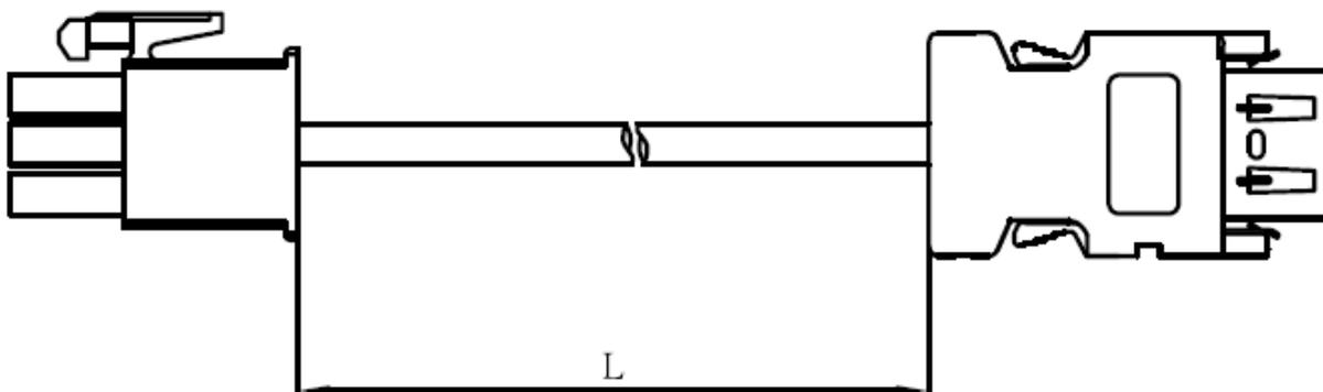
低/中慣量編碼器線：低慣量 1KW、1.5KW、2.0KW、3.0KW
