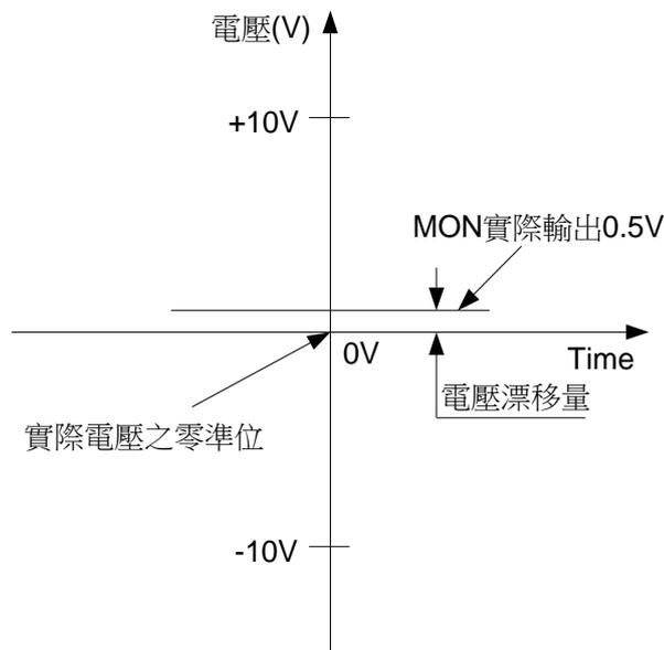
假設馬達轉速為 0 rpm，此時由類比輸出監控(MOD)觀看到之電壓值應為 0V。由上圖可知，MOD 輸出之類比電壓與實際電壓相差了 0.5V，此時只要將 PC28 或 PC29 設為-500，如此即可將 MOD 之類比電壓校正到與實際電壓相同之值。若 MOD 類比電壓比實際電壓值小，請在 PC28 或 PC29 輸入正值。
