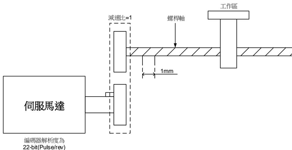
由上圖可以看出負載(螺桿軸)轉一圈移動距離為 1mm，馬達解析度為 22-bitPulse/rev，假設想要負載軸轉 5 $\mu$ m，代入電子齒輪比公式：
