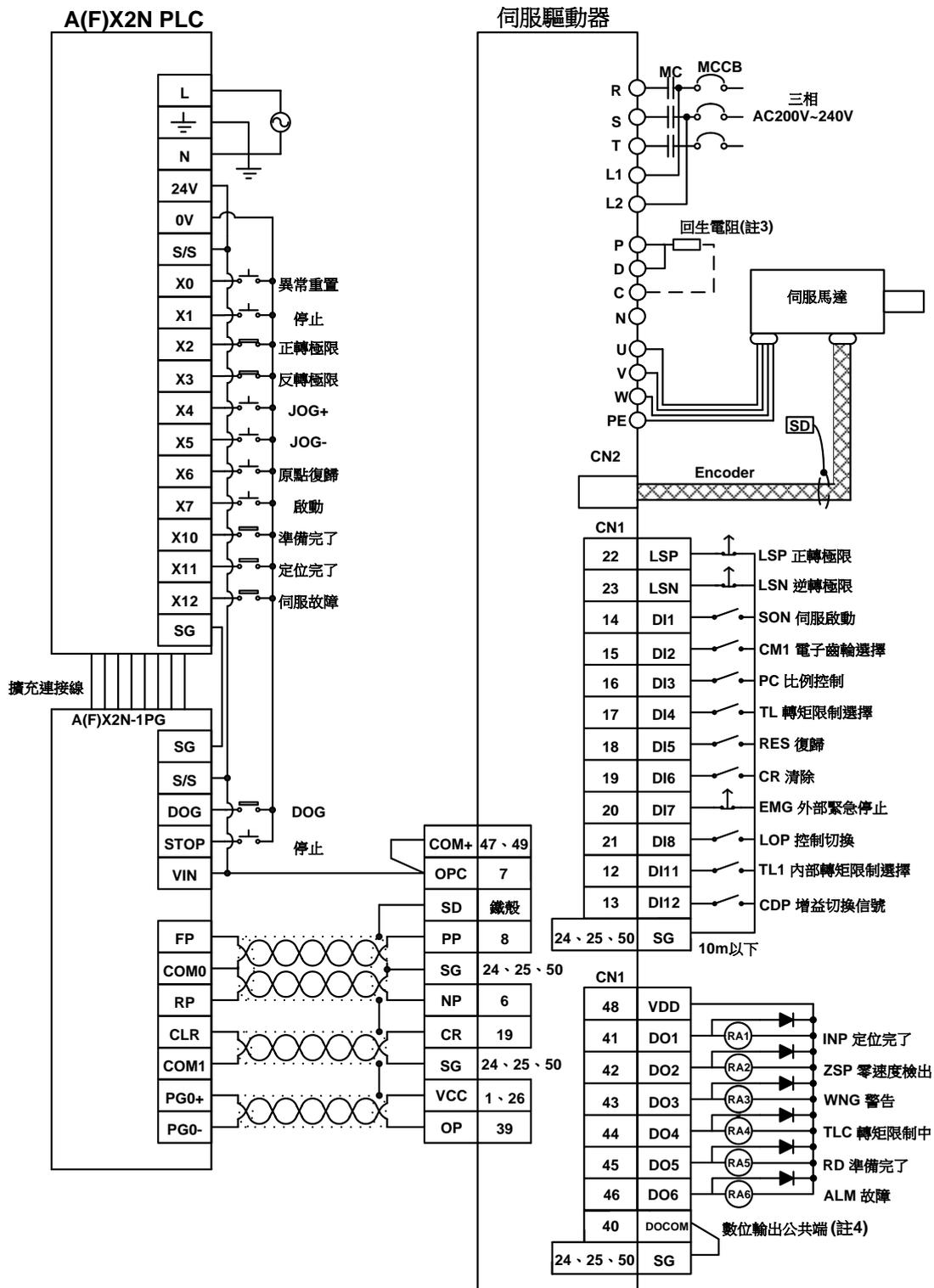
註1. COM+、OPC使用PLC提供之DC24V，VDD與COM+不可短接
