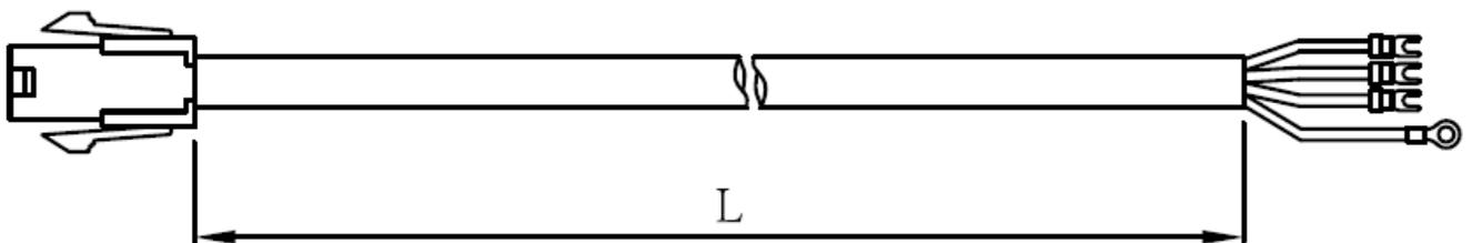
中/低慣量動力線：低慣量 1KW、1.5KW、2.0KW、3.0KW / 中慣量 1KW、1.5KW 使用
