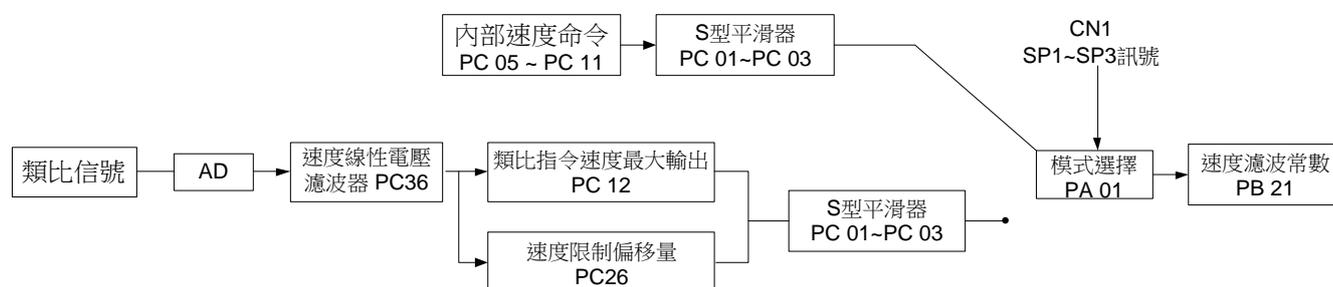
圖形上半部，為內部速度命令，也就是速度命令大小是由使用者寫入參數內再由數位輸入端子 DI 來進行切換的。而圖形下半部為外部類比輸入 $\pm 10V$  電壓，經由 A/D 處理後，計算使用者設定之類比命令最大輸出(比例器)與電壓漂移量後輸出。
