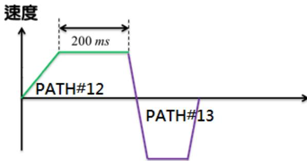
**重疊命令：**在依序命令中，若有定位控制接續定位控制，其前段的定位可選擇是否允許下段定位控制命令重疊。而何謂重疊，即前段定位命令在減速區段時馬上重疊下一段定位命令的加速區段，可使前後兩定位控制很平順的銜接。
