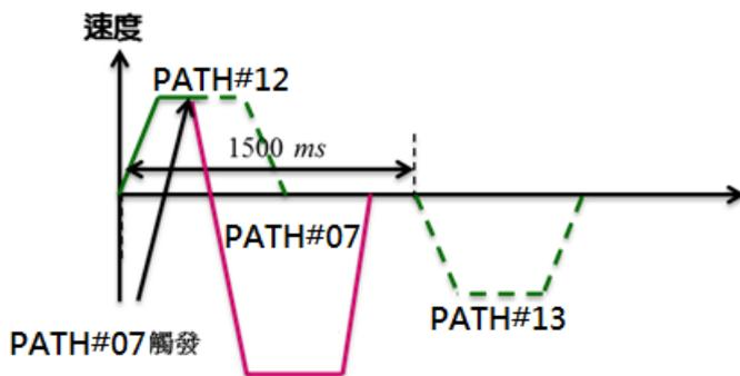
此外若程序正在執行時有外部觸發新的程序，但此程序並無設定插斷，則必須等正在執行的程序完成後，才會執行觸發的程序，如下圖所示。
