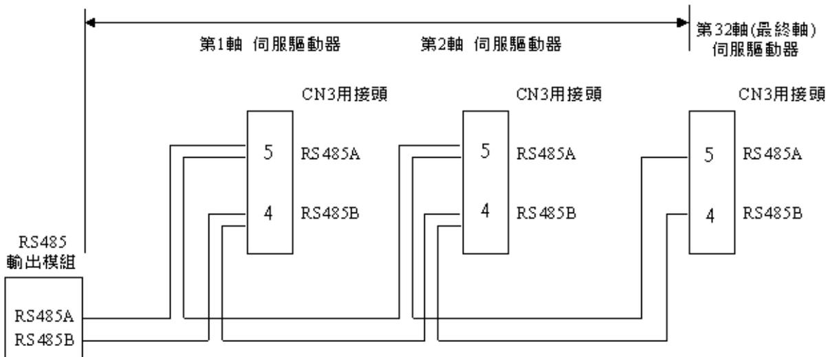
注1：雜訊少的環境下線長為100公尺，若傳輸速度在38400bps以上時，建議使用15公尺以內之線長以確保傳輸準確率
