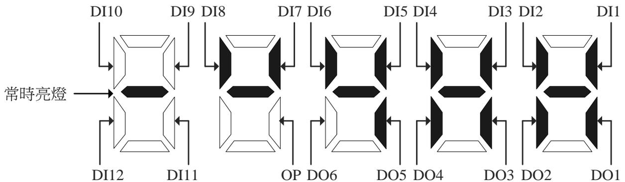
以已顯示的 7 段 LED 表示 ON/OFF，各段的上部為輸入訊號(DI1~DI10)，下部為輸出訊號(DO1~DO6、OP)與輸入訊號 DI11、DI12，以上圖為範例，DI1~DI8 為 ON 的狀態，DI9~DI12 為 OFF 狀態，DO1~DO5 為 ON 狀態，DO6、OP 為 OFF 狀態。
