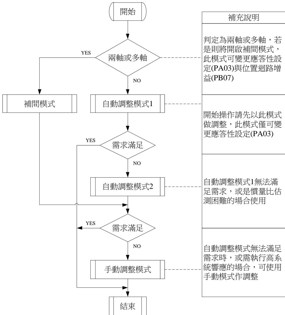
若伺服架設場合為初次使用，請先以 JOG 模式試運轉，伺服沒有異狀後再使用自動調諧功能。操作自動調整模式時，需使伺服產生多次加減速命令，待慣量比估測驅於穩態後，以達到估測慣量比與頻寬搜尋的目的。
