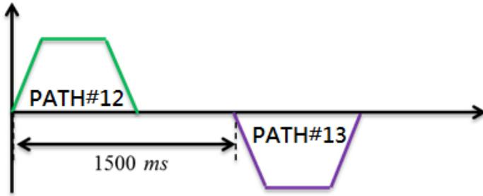
內部插斷須注意其延遲時間不可小於該段程序完成的時間，否則將會出現在前段程序未完成，並被後段程序插斷，如下圖所示。
