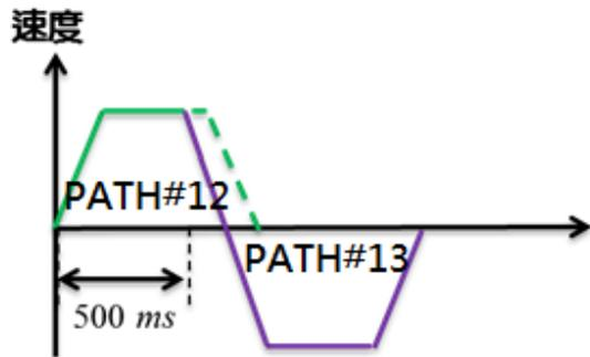
**外部插斷**：內部與外部插斷最大的差異就是，其後段具有插斷程序的觸發，前者是由依序命令所規劃的，但後者卻是由外部觸發來執行後段程序。除此之外，外部插斷發生時前段程序所設定的延遲時間無效。如下列範例所示：
