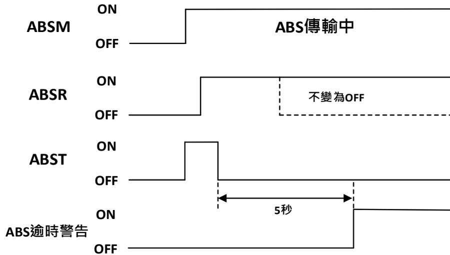
(3) ABSM 傳輸模式結束後的逾時檢查
