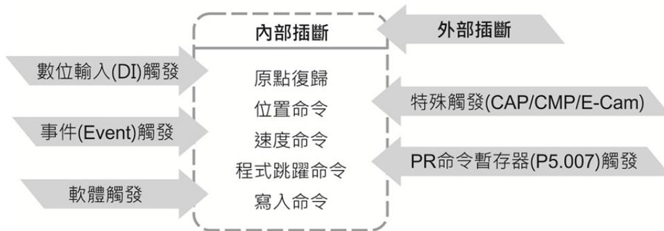
圖 7.1.6.5 內部插斷與外部插斷示意圖
