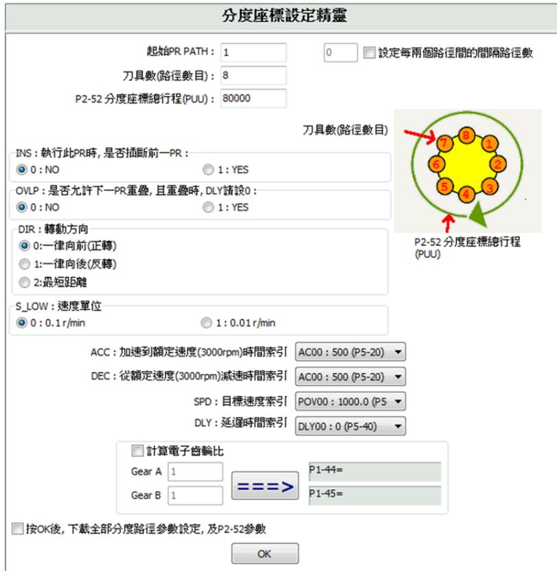
圖 7.1.3.13 PR 模式分度座標設定精靈使用者介面
