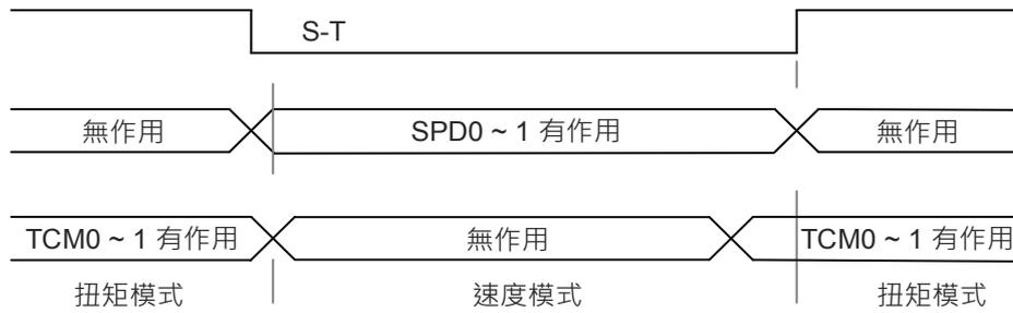
圖 6.5.2.1 速度/扭矩混合控制模式
