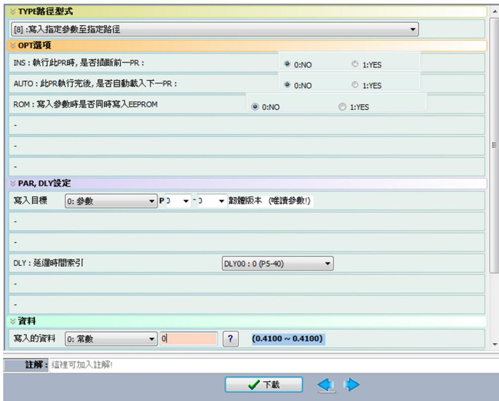
圖 7.1.3.11 ASDA-Soft PR 模式寫入命令使用者設定介面
