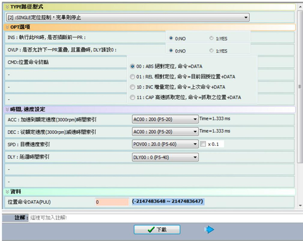
圖 7.1.3.6 ASDA-Soft PR 模式定位控制使用者設定介面
