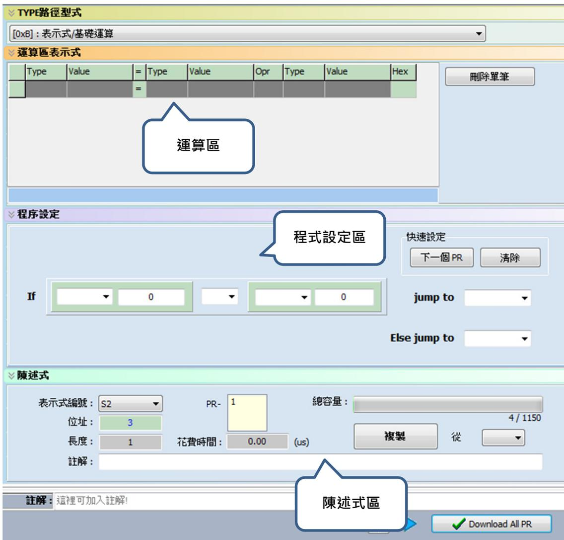
圖 7.1.3.16 ASDA-Soft PR 模式基礎數值運算使用者設定介面
