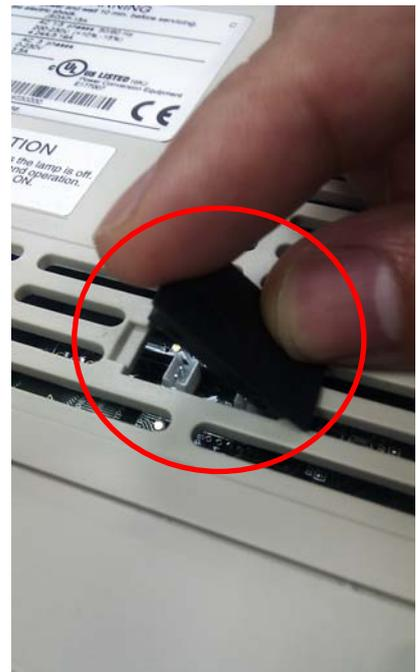
3. 移除保護蓋後，可看到兩個連接接頭，選擇其中一個即可，參考電池模組所附說明書，將電池接頭連接，另一個接頭是預留在更換電池時，可先將新電池接上，再將舊電池移除，避免電源供應中斷。
