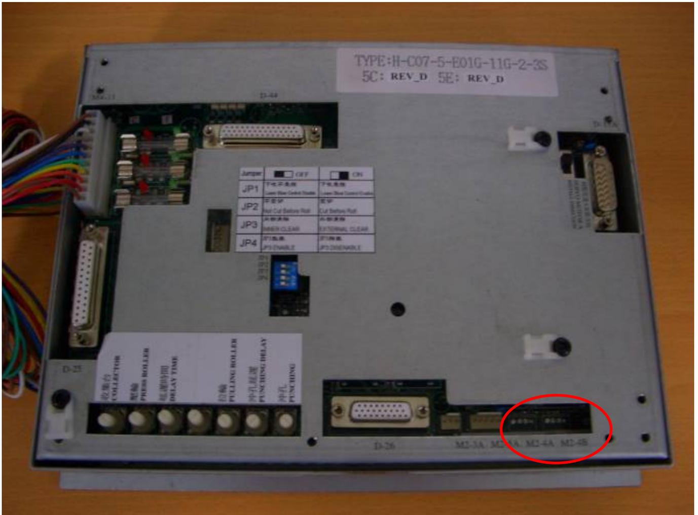
2. 將控制箱內 C09 配線母板上的給料 A 組信號，移到給料 B 組信號輸入端。
