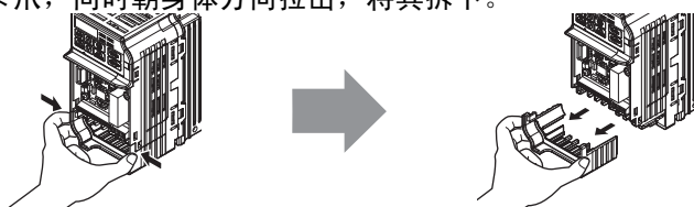
图 3.7 下部外罩的拆卸方法（柜内安装型）
